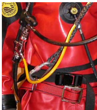
Beispiele der Anbringung der Entlastungsschleife am Sicherheitsgurt
