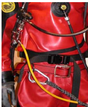
Beispiele der Anbringung der Entlastungsschleife am Sicherheitsgurt
